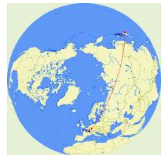
Figura A.2: A menor distância por exemplo entre o Aeroporto de Frankfurt e o de Haneda, no Japão, é dada pelo arco de um grande círculo. Essas são as rotas seguidas pelos aviões que ligam estas cidades.
